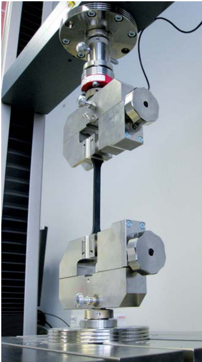
▲ Abbildung 4 Zugprüftests an Kunststoffproben
